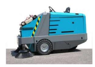
TSM Durasweep 170 является автономной - самоходная машина приводится в движение двигателем внутреннего сгорания или электродвигателем, которые, при помощи вращающихся щеток и всасывания позволяют очищать большую площадь. Большая емкость бака для мусора, контроль за пылью с DCW системой (Dust Control with Water) и возможность установки фильтра гарантируют хорошую подметальную производительность. Машина
