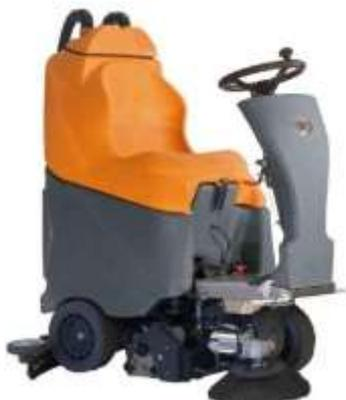
Компактная и простая в использовании поломоечная машина TSM GRANDE BRIO RIDE ON 75-C62 (1s) идеально подходит для уборки крупных коммерческих и промышленных объектов, позволяет пройти через небольшие пространства или проходы, стандартные двери 80 см. Центр тяжести находится очень низко, с батареями вес сосредоточен на середине пути между передними и задними колесами. Благодаря этому, машина способна преодолевать уклон в 5%.
