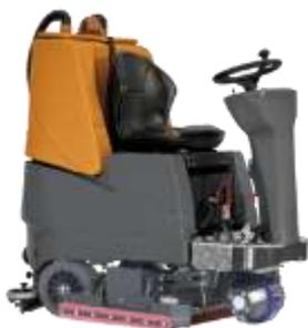
**Grande Brio Ride 115 - C82** - это комбинированная поломоечно-подметальная машина с оператором на борту, самая большая из ассортимента Grande Brio. Она включает две центральные цилиндрические щетки и бак для сбора грязи на 120 литров.
